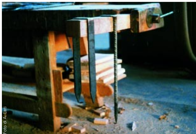
15. Diversi picchetti d'ancoraggio a terra dell'annesso lunghi 50-60 cm
